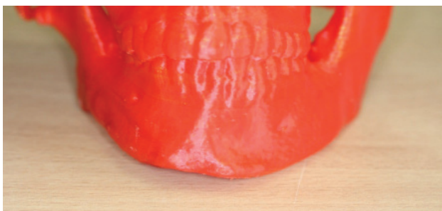
Фото 7. Стереолитографическая модель для индивидуального моделирования титанового имплантата
